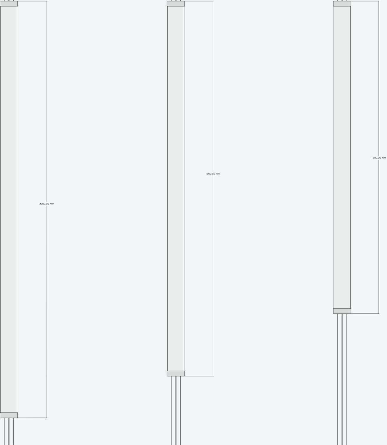
Tube80 Pendel vertikal, mehrfach, 1000mm, Netzteil extern
