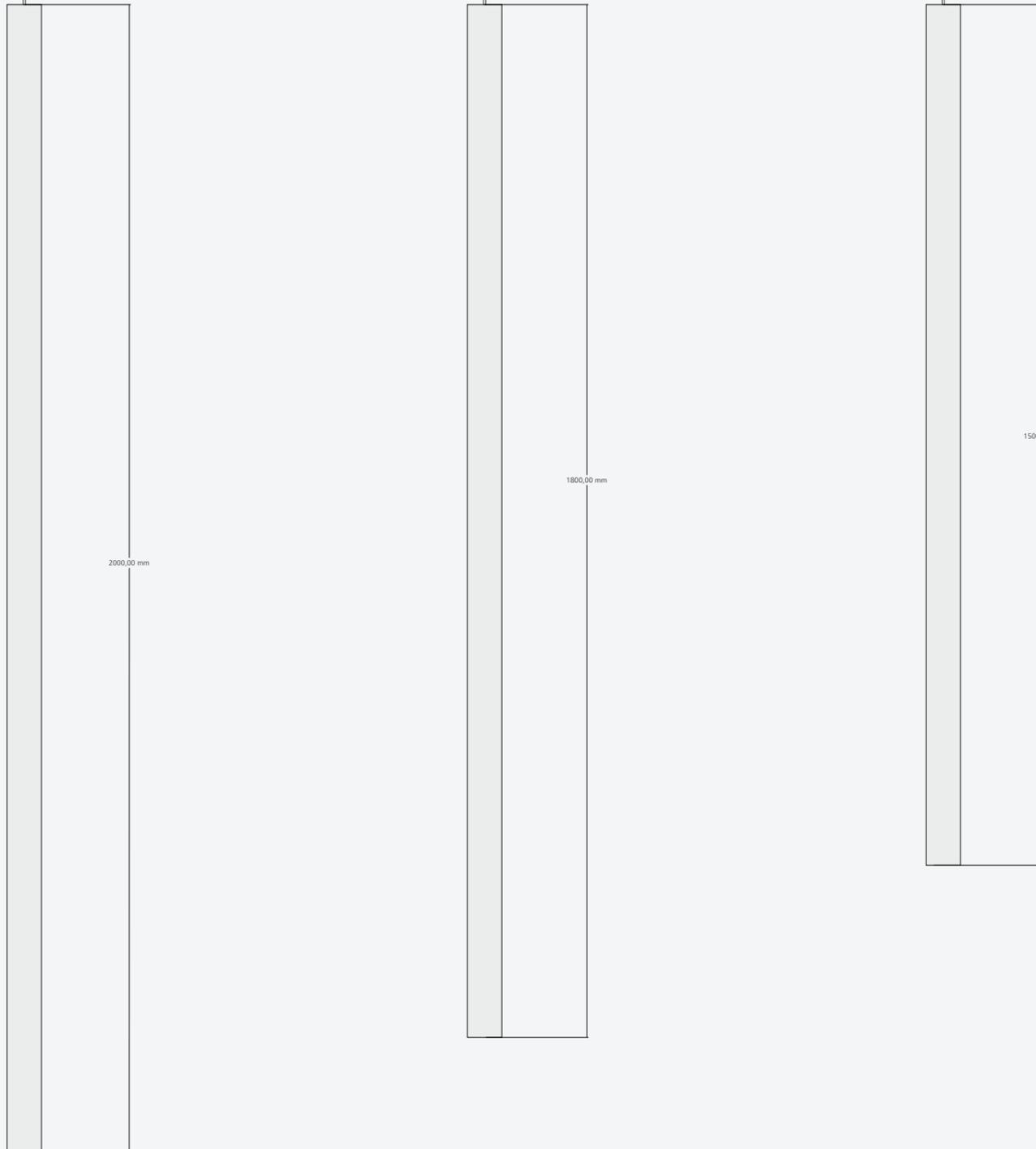
Tube60 Pendel vertikal, 1000mm, Netzteil extern
