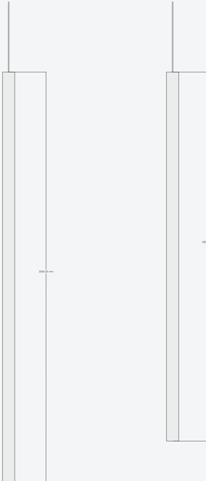
Tube60 Pendel vertikal, 1500mm, Netzteil extern
